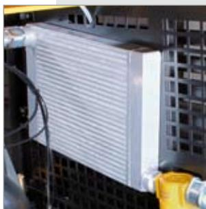
L'aria compressa viene raffreddata a 7 °C oltre la temperatura ambiente. L'installazione inclinata del radiatore aria facilita l'espulsione della condensa che evapora grazie al calore dei gas di scarico. Il rischio di congelamento durante il periodo invernale è scongiurato.
