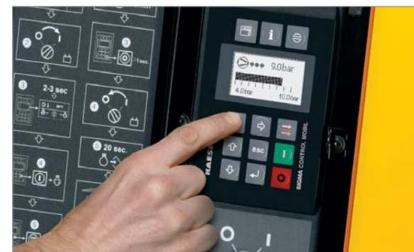
L'agevole fruibilità dell'innovativo sistema di gestione SIGMA CONTROL MOBIL e la sua ottimale armonizzazione tra motore e compressore produce un notevole risparmio di carburante in questi motocompressori con portate fino a 34,0 m³/min.
