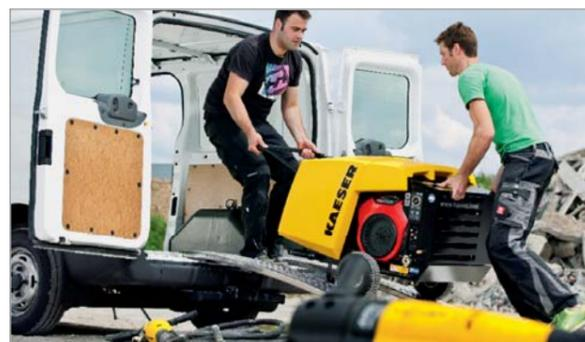
I compressori MOBILAIR della serie più piccola sono in grado di azionare diversi attrezzi pneumatici: vanghe, martelli, trapani, seghe, avvitatori, levigatrici e perfino lance ad aria compressa. La versione a 15 bar è ideale per la posa dei cavi in fibra ottica o per eseguire test di tenuta. A richiesta un radiatore finale esterno garantisce aria compressa fredda e priva di condensa.
