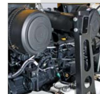
**Filtri aria distinti per motore e compressore**
