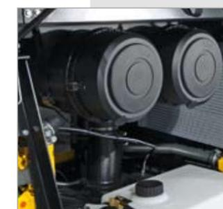
**Filtri aria distinti per motore e compressore**
