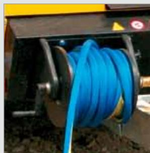
L'avvolgitubo assemblato in fabbrica è equipaggiato con 20 m di tubo flessibile leggero che per l'impiego non è necessario srotolarlo completamente. L'accurato alloggiamento oltre a proteggere il tubo da eventuali danni (strozzature, allungamenti e schiacciamenti) e impurità, ne assicura una migliore disponibilità ed una maggiore longevità.
